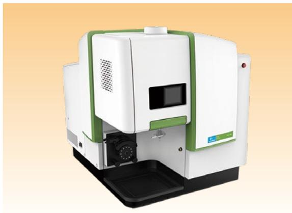
高速起動が可能なハイブリット型スキャニング CCD 搭載 ICP-OES。あらゆる波長域を優れた感度と分解能で測定可能です。フラットプレートプラズマテクノロジー、プラズマカム、デュアルビューは Avio 5x0 Max と同様に搭載されています。
