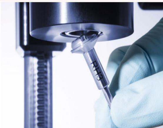
マグネット着脱方式を採用することで、測定治具と本体の接続箇所の**故障リスクを大幅緩和!**
