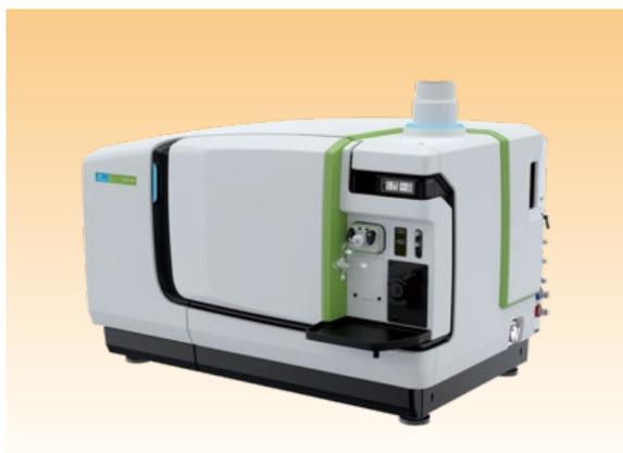
NexION 5000 は、最も困難なアプリケーションに対処するために設計された、真のトリプル四重極を搭載した革新的なマルチ四重極 ICP-MS です。従来のトリプル四重極 ICP-MS を超える比類ないスペクトル干渉の除去、優れた感度、卓越した検出下限を実現します。
