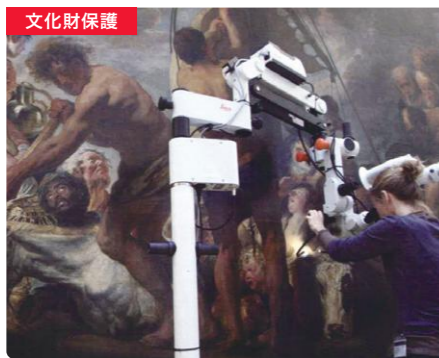
美術品修復に利用される可搬式（フロアスタンド） 実体顕微鏡
